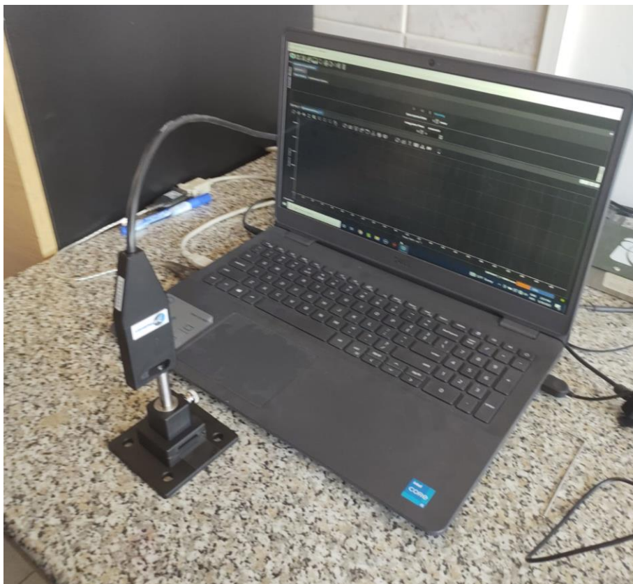
Figura 22 Spectrometrul Raman portabil cuplat la diodă laser și laptop folosiți pentru obținerea spectrelor SERS ale pansamentelor plasmonice
