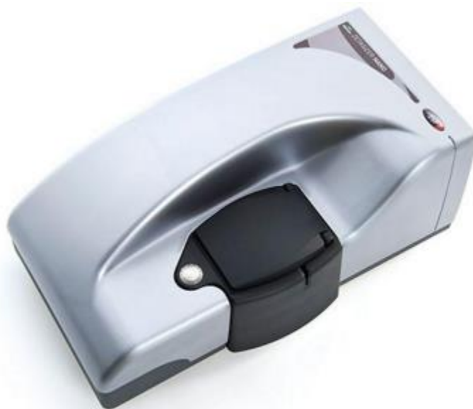
Figura 21 Instrumentul folosit pentru a măsura potențialul Zeta al nanobipiramidelor
