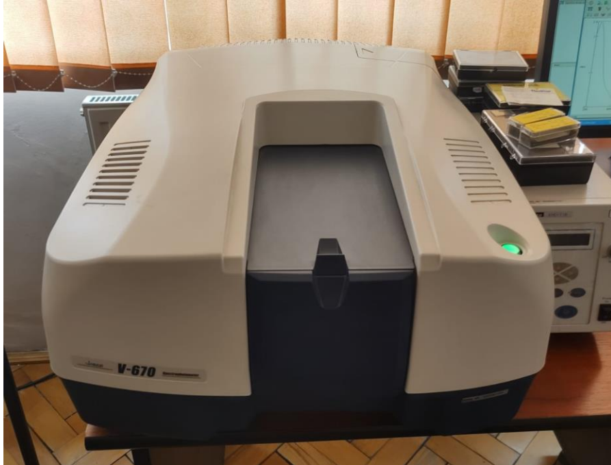
Figura 19 Spectrometrul UV-Vis-NIR folosit pentru obținerea spectrelor de extincție ale soluțiilor coloidale de nanobipiramide
