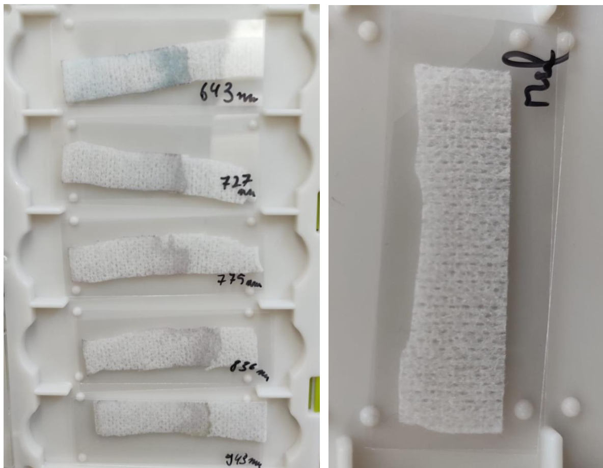
Figura 14 Stânga: Fâșii de bumbac imersate în soluții coloidale cu răspunsuri plasmonice diferite. Dreapta: Fâșie de bumbac folosită ca referință.
