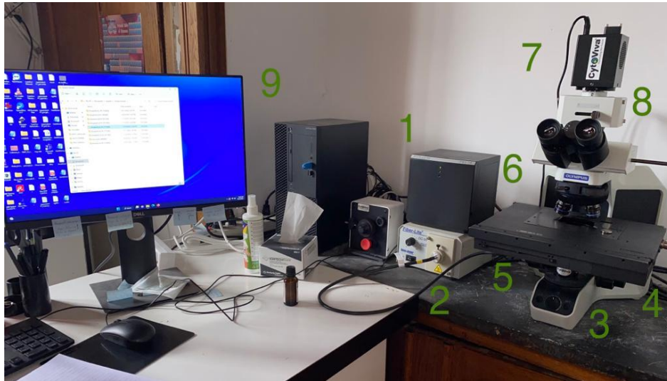
Fig. 1.4 Componentele sistemului CytoViva – microscopul hiperspectral în câmp întunecat.
