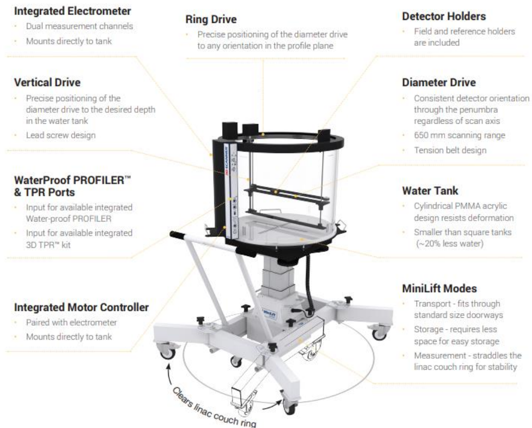
Figura 4.5. Părțile componente ale 3D Scanner Sun Nuclear[32]
