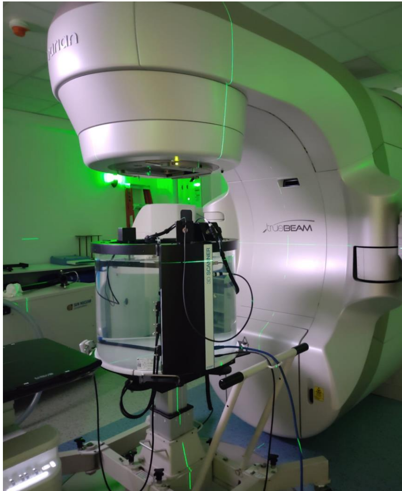
Figura 4.6. Poziționarea fantomului 3D Scanner la aparat
