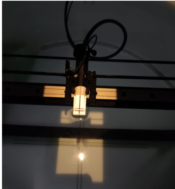
Figura 4.8. Poziționarea camerei de ionizare SNC125c cu ajutorul capacului de setup
