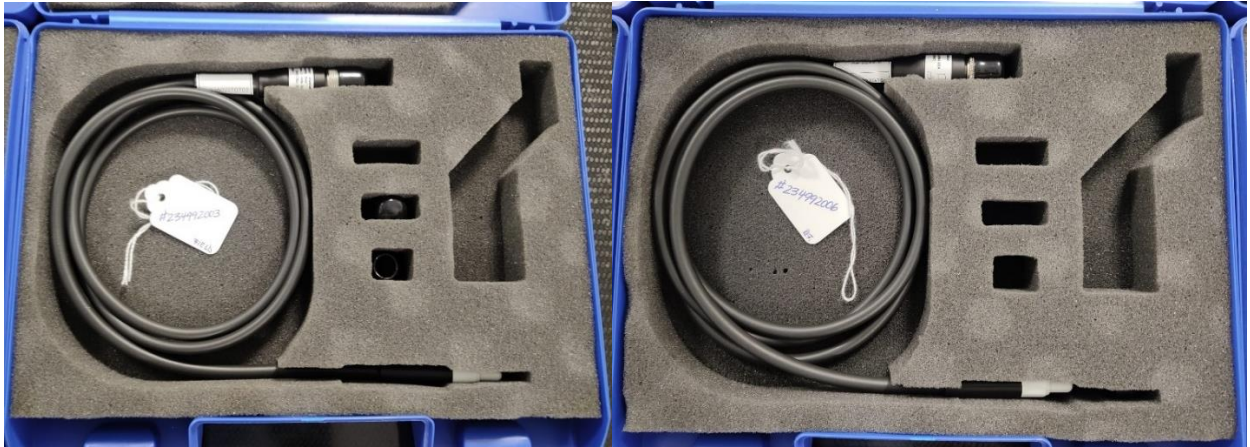
Figura 4.4. Camerele de ionizare SNC125c utilizate (în dreapta camera field iar în stânga camera de referință)
