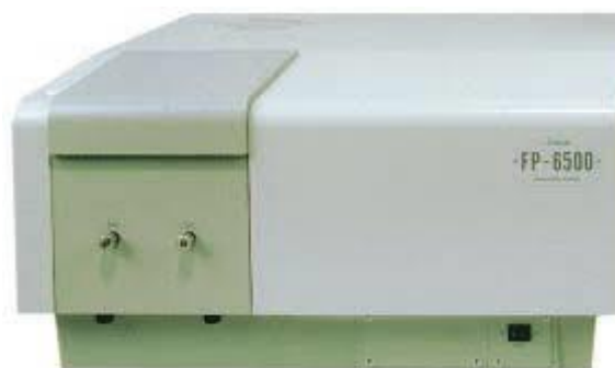
Fig. A4.1 Aparatul spectrofluorometru Jasco FP6500 folosit în cadrul măsurătorilor din această lucrare [25]
