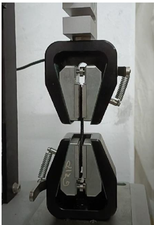
Figură 2.5 Probă supusa unui test de rupere
