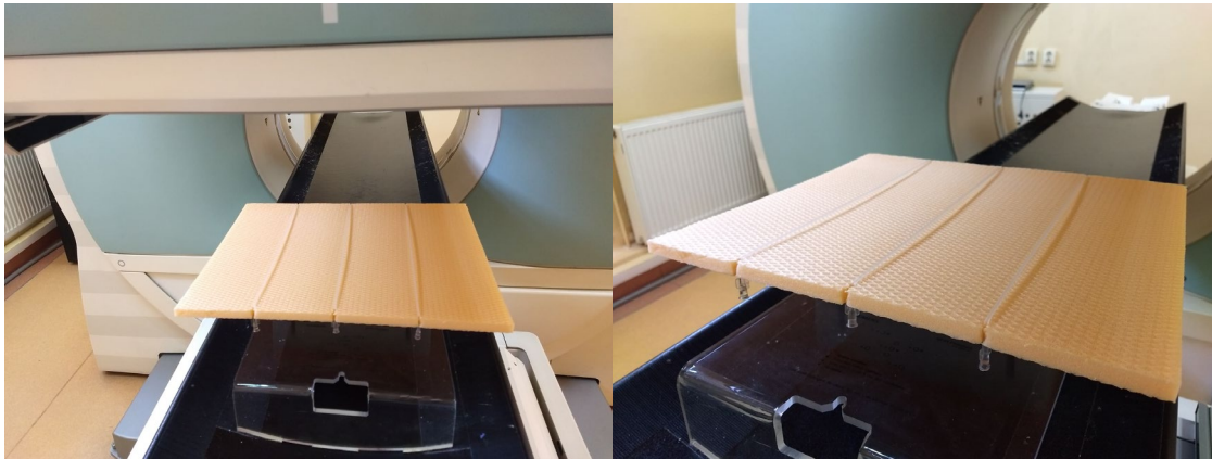
Figura 3.1 Cele trei surse liniare așezate pe suport sub detector.
