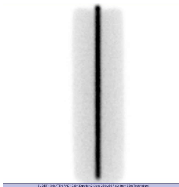
Figura 3.19 Imaginea obținută cu camera gamma pentru o sursă liniară cu atenuator radioactiv folosind detectorul 1.
