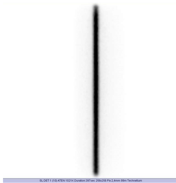
Figura 3.18 Imaginea obținută cu camera gamma pentru o sursă cu atenuator folosind detectorul 1.
