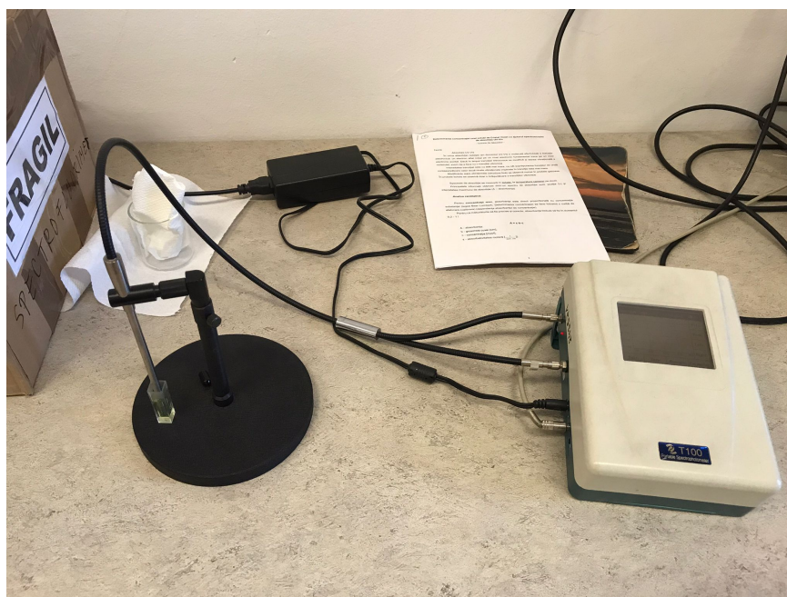
Figura 2.4: Spectrofotometrul de absorbție T100
